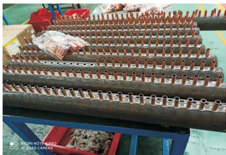
图3 校正集管和连接毛细管
