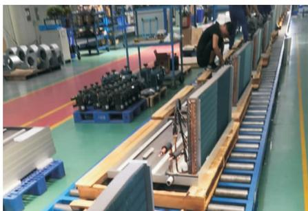
图2 流水线上换热器生产与加工
