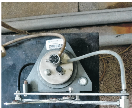
图6 倾斜式微压计校零和测压切换
