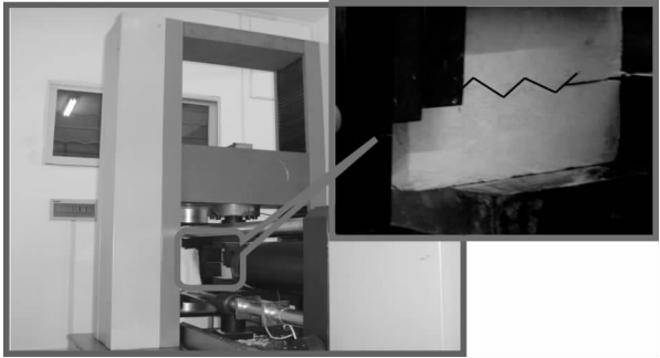
图2 锯齿状粗糙结构面剪切试验
