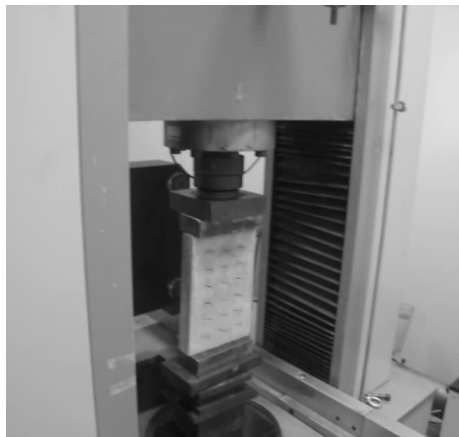
图1 单轴压缩条件下多裂隙试件的变形破坏试验图
