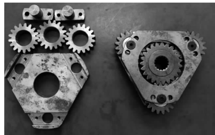
图7 行星齿轮减速器实物
